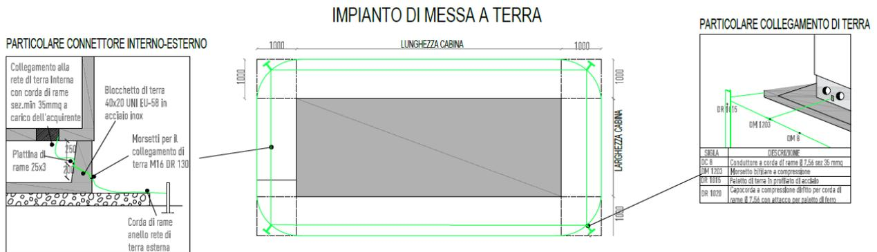
Figura 3 - Dettagli impianto di terra cabina di consegna
